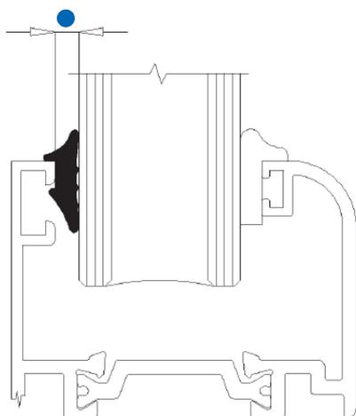
Le nostre guarnizioni fermavetro **MEZZA LUNA EPDM** sono studiate per essere impiegate sui principali sistemi di profilo.
