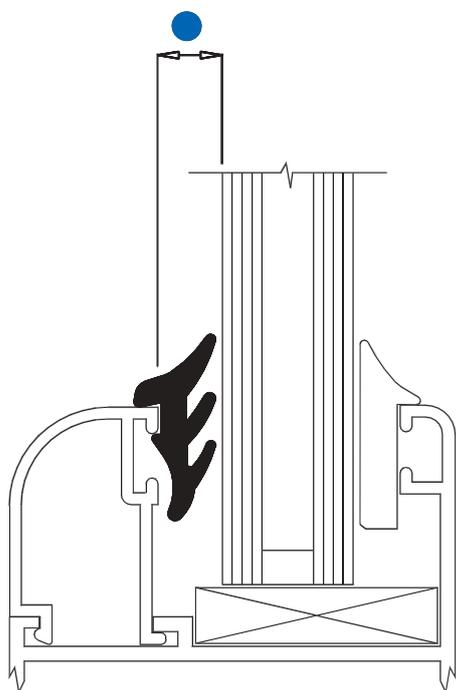
Le nostre guarnizioni fermavetro **UP in EPDM** sono studiate per essere impiegate sui principali sistemi di profili. La loro geometria e la lubrificazione superficiale rendono agevole la messa in opera.
