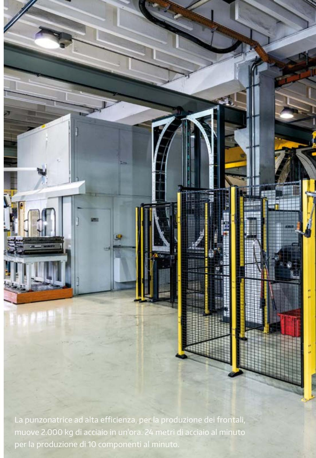
La punzonatrice ad alta efficienza, per la produzione dei frontali, muove 2.000 kg di acciaio in un'ora. 24 metri di acciaio al minuto per la produzione di 10 componenti al minuto.
